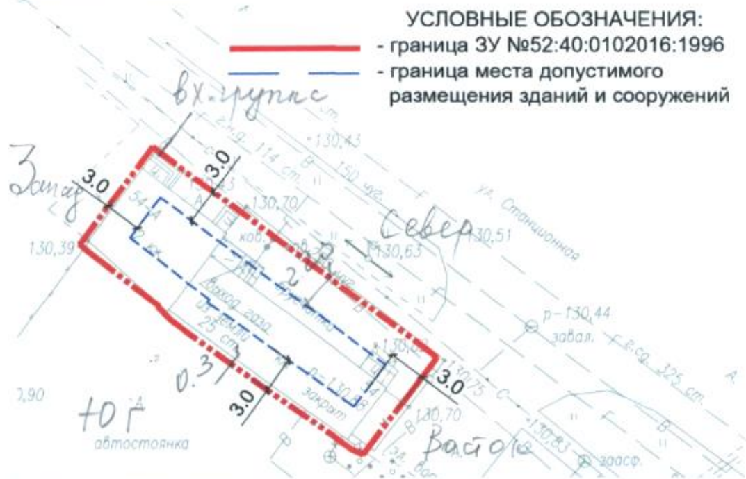
Рис.1 - Минимальные отступы от границы земельного участка и место допустимого размещения здания, согласно данным ГПЗУ №РФ-52-2-02-0-00-2023-А0
